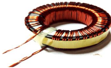
Gambar 2.11 Induktor Bentuk Core
