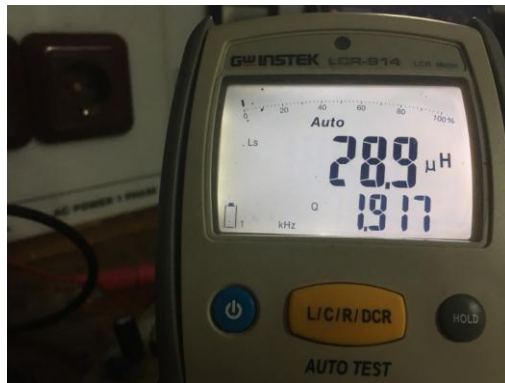
Gambar 4.18 Pengujian Nilai Induktansi Diukur Dengan LCR Meter
