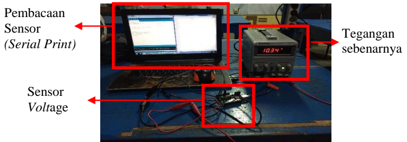
Gambar 4.11 Pengujian Sensor Tegangan
