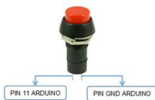
Gambar 3.13 Konfigurasi Pin Push Button 1
