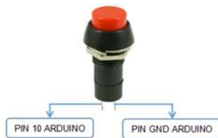
Gambar 3.14 Konfigurasi Pin Push Button 2
