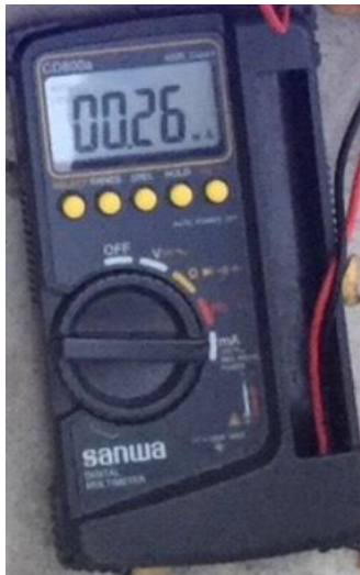
Gambar 4.8 Tampilan Saat Pengukuran Arus Sensor DS18B20
