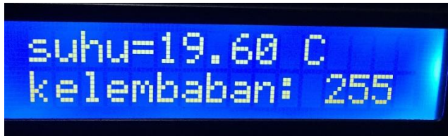
Gambar 4.2 Tampilan Data ADC Saat Kondisi 0% Sebesar 255 bit
