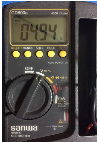
Gambar 4.4 Pengukuran Tegangan Saat Kelembaban 0% Sebesar 4,94 V
