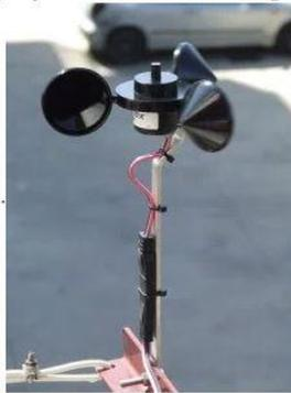
**Gambar 2.4** Anemometer
