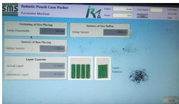
**Gambar 4.20** Hasil tampilan HMI pada menu parameter
