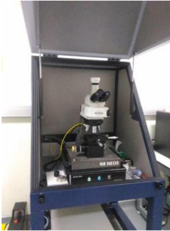
Gambar 3.5 Alat pengujian AFM
