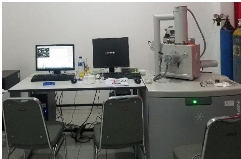
Gambar 3.3 Alat pengujian SEM-EDX
