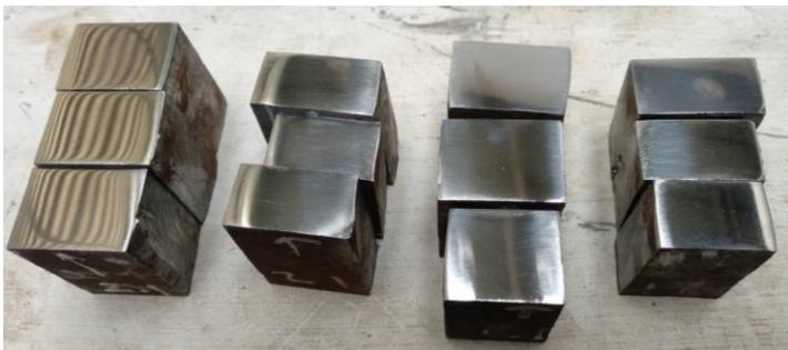
**Gambar 3. 7** Benda Kerja Yang Akan Diuji Kekerasan Permukaan
