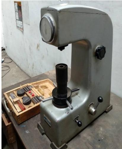
**Gambar 3. 10** Alat Ukur Uji Kekerasan Permukaan
