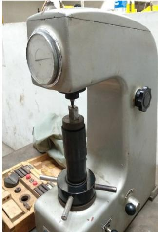
**Gambar 3. 11** Proses Pengukuran Kekerasan Permukaan
