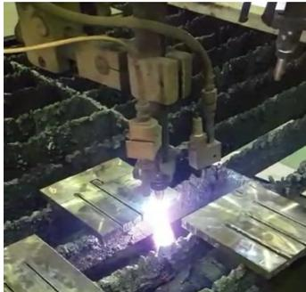
**Gambar 3. 3** Posisi Torch Pada Awal Pemotongan
