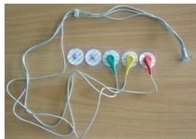
Gambar 4.10 Elektroda Ag/AgCl dan Kabel Konektor ke Rangkaian *Electromyography* (EMG)
