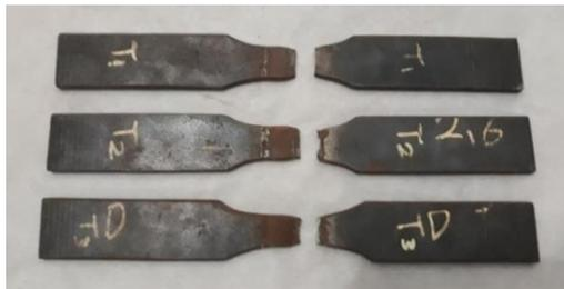
**Gambar 4.2** Pengujian Tarik Pada Spesimen 3 Layer dengan letak patahan pada daerah HAZ
