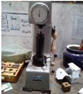
**Gambar 3.13** Alat Uji Kekerasan Rockwell
