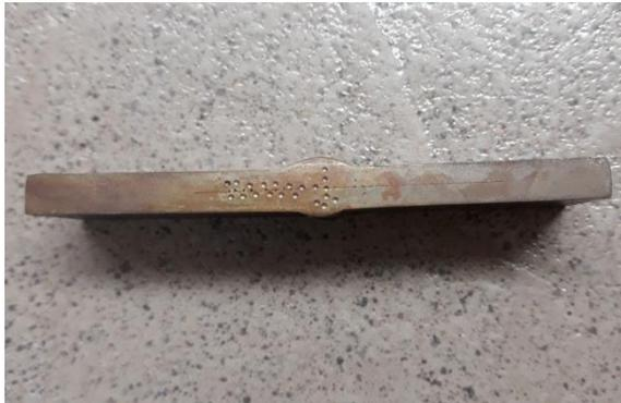
**Gambar 4.6** Letak Indentasi pada Uji Kekerasan pengelasan 3 layer
