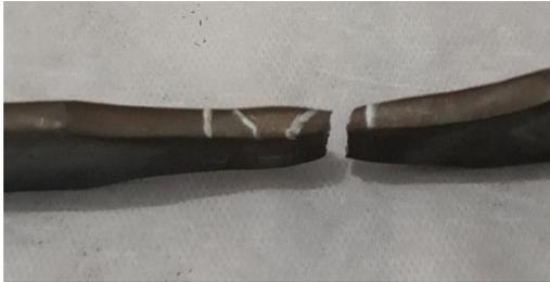
**Gambar 4.4** Daerah Putus Pada Spesimen SA 36 Dengan 3 Layer Terletak Pada *HAZ*
