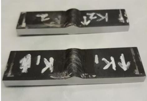
**Gambar 3.15** Spesimen sebelum di etsa
