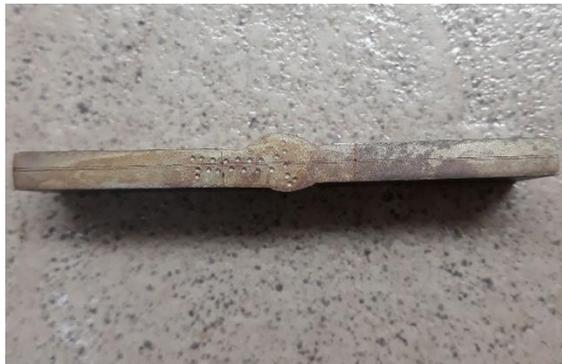
**Gambar 4.7** Letak Indentasi pada Uji Kekerasan pengelasan 2 layer
