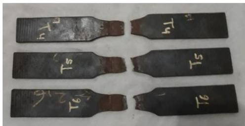
**Gambar 4.3** Pengujian Tarik Pada Spesimen 2 Layer dengan letak patahan pada daerah HAZ
