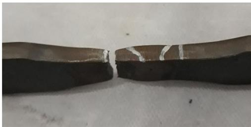
**Gambar 4.5** Daerah Putus Pada Spesimen SA 36 Dengan 2 Layer Terletak Pada *HAZ*
