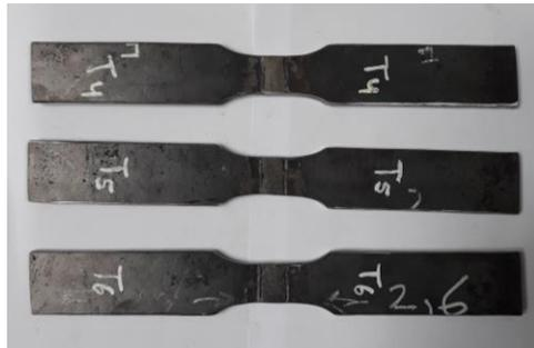
**Gambar 3.12** Spesimen Uji Tarik 2 Layer
