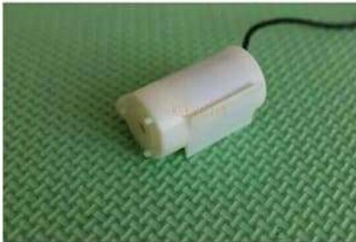
**Gambar 3.5** Pompa Air yang Digunakan
