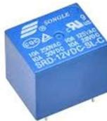
**Gambar 2.15** Bentuk Fisik Relay
