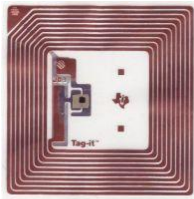
Gambar 2.5 Tag RFID (Sumber : Chon, 2005)
