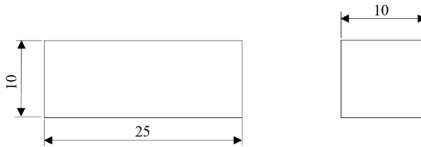
Gambar 3.2 Dimensi Benda Uji Metalografi
