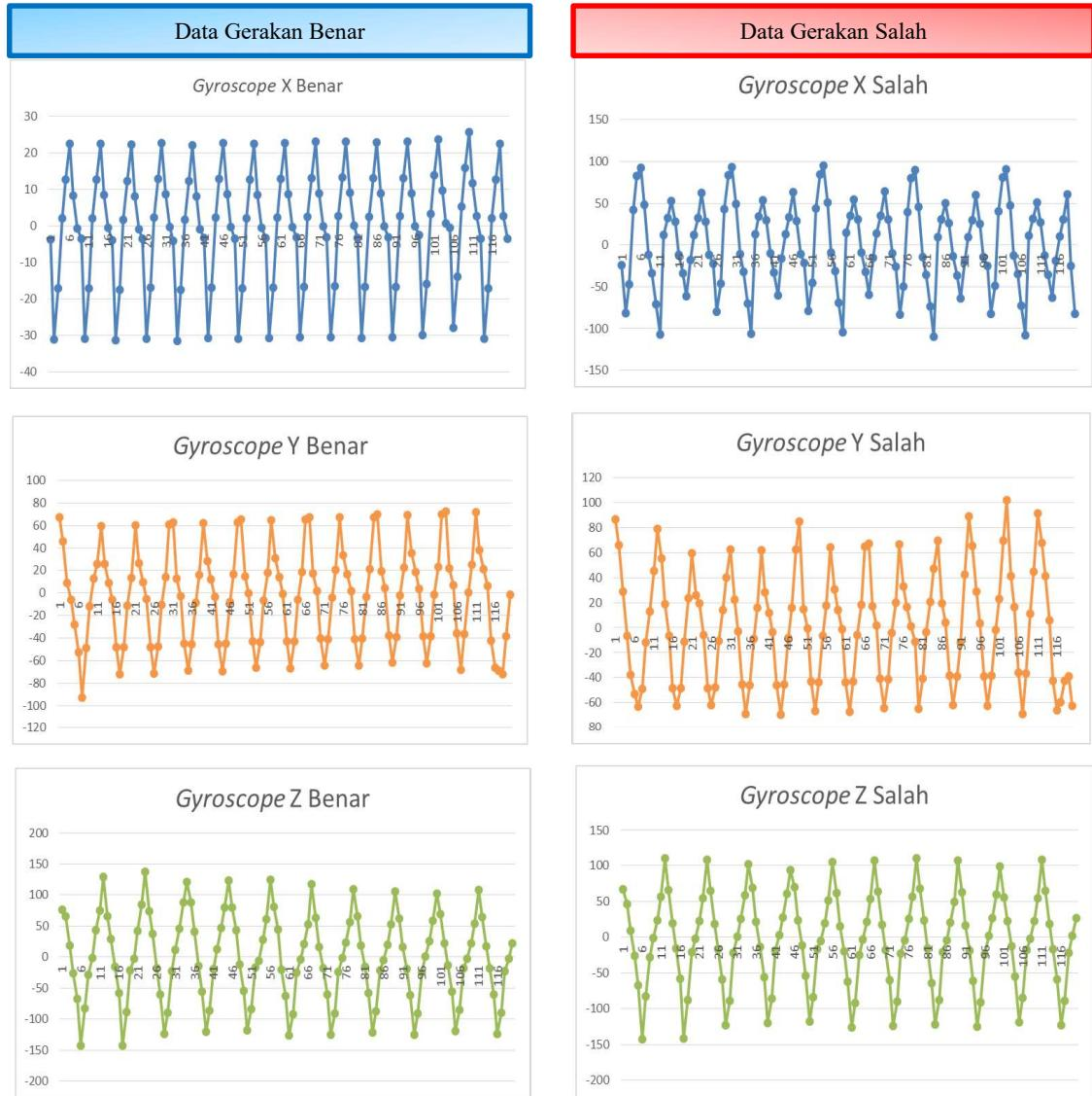
Gambar 6.16 Perbandingan *Ouput* Grafik Sensor *Gyroscope* Metode *Spraying* Data Benar Vs Data Salah
