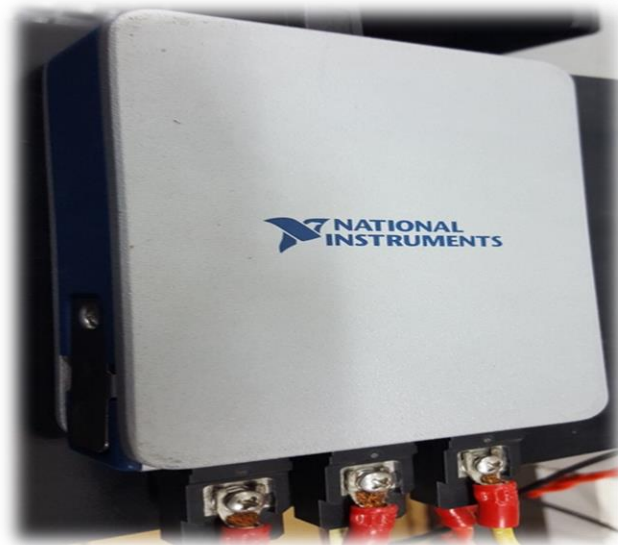
Gambar 3.2 alat akuisisi data type NI-DAQ 9246
