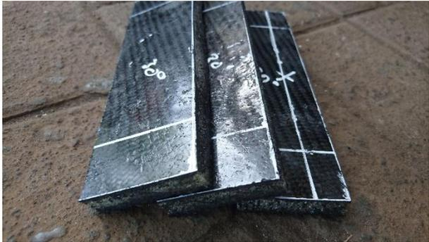
Gambar 3.11. Pemotongan dengan sudut  $30^\circ$
