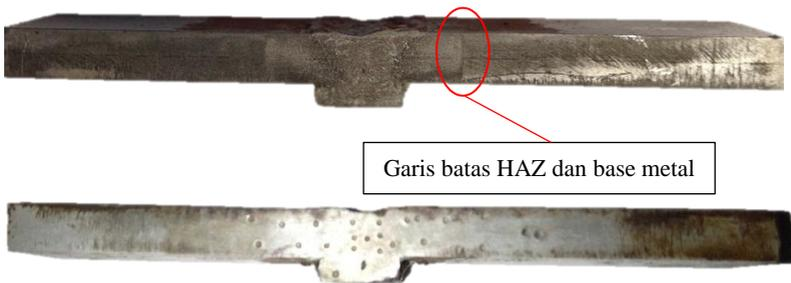
**Gambar 4.4** Hasil Pengujian Kekerasan Spesimen V-groove
