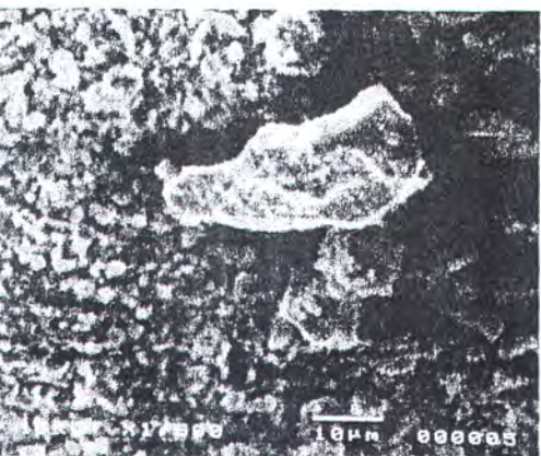
b. Hasil SEM untuk kalsinasi serbuk ferit \text{NiFe}_2\text{O}_4 pada suhu 600^\circ\text{C}
