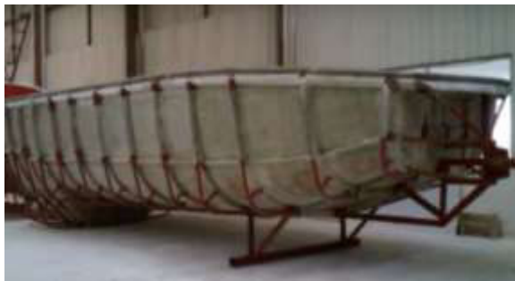
Gambar 5.24 Cetakan Canopy dan Lambung Sekoci Penolong + Framework (Sumber : Vanguard Pte.Ltd)
