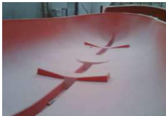
Gambar 5.25 Hasil Jadi Laminasi Lambung dan Hull Liner Sekoci Penolong (Sumber : Vanguard Pte.Ltd)
