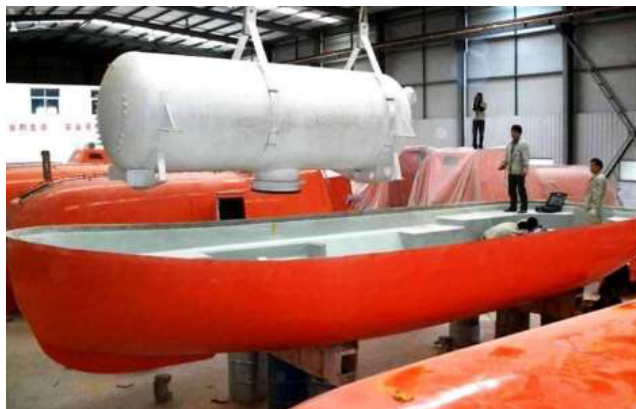
Gambar 5.27 Proses Pemasangan Tangki pada Sekoci Penolong Tipe Hiperbaric (Sumber : Vanguard Pte.Ltd)
