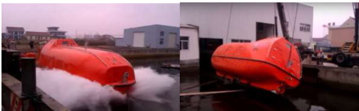
Gambar 5.28 Dropping Test (Kiri) dan Impact Test (Kanan)
