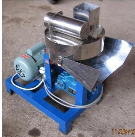
**Gambar 2.3.** Mesin Pemotong Singkong, Talas, dan Pisang Dengan Motor Listrik
