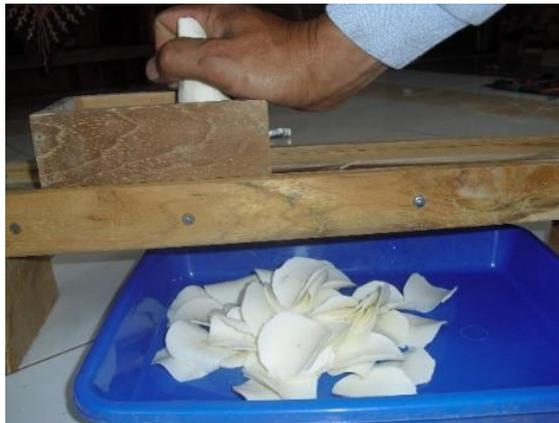
**Gambar 2.1.** Alat Pemotong Singkong, Talas, dan Pisang Sederhana
