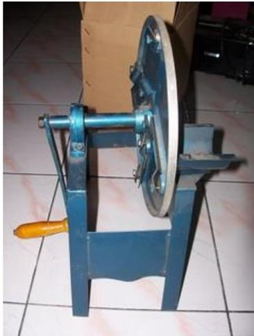
**Gambar 2.2.** Mesin Pemotong Singkong, Talas, dan Pisang Manual
