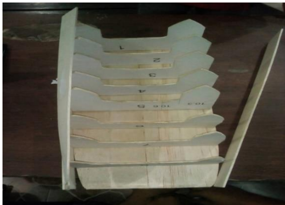
Gambar 2.3 Pembuatan Kerangka Body Kapal (Falah dkk,2017)
