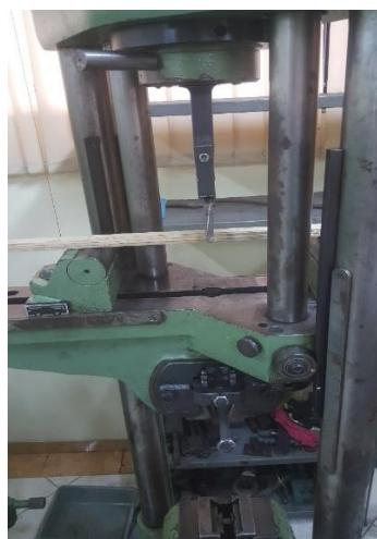
Gambar 3.10 Proses Pengujian Tekuk
