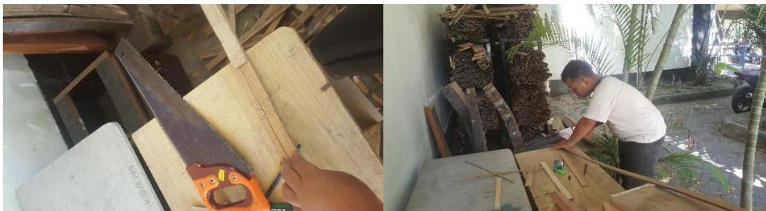
Gambar 3.6 Potongan Bilah Sepanjang 50 dan 70 cm
