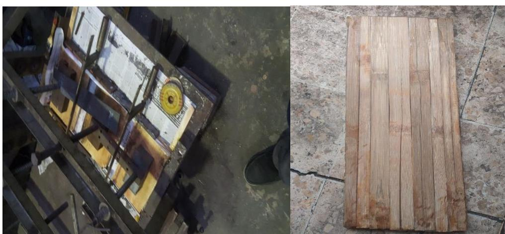
Gambar 3.4 Alat Press Laminasi untuk pembuatan papan laminasi
