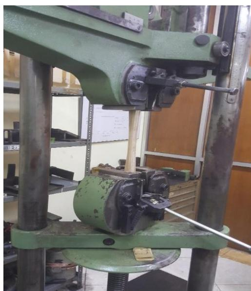
Gambar 3.9 Proses Pengujian Tarik
