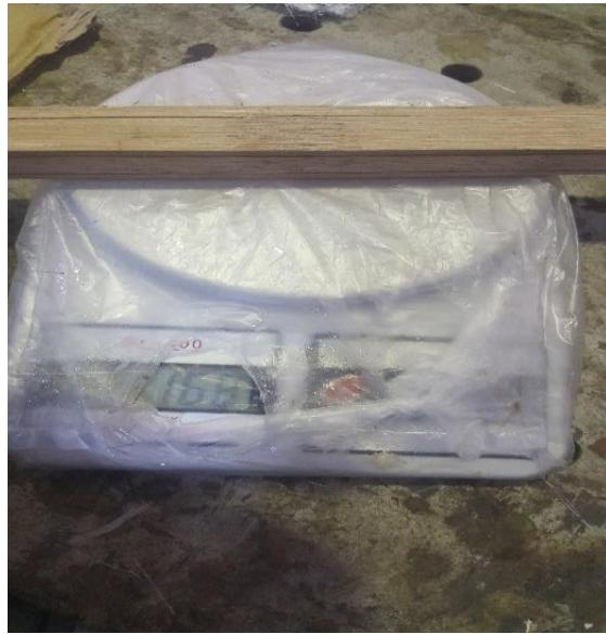
Gambar 4.1 Pengukuran berat laminasi *hybrid* bambu
