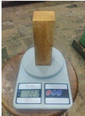
Gambar 4.1 Pengukuran berat kayu spesimen
