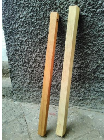
Gambar 3.10 spesimen uji lentur ( bending )
