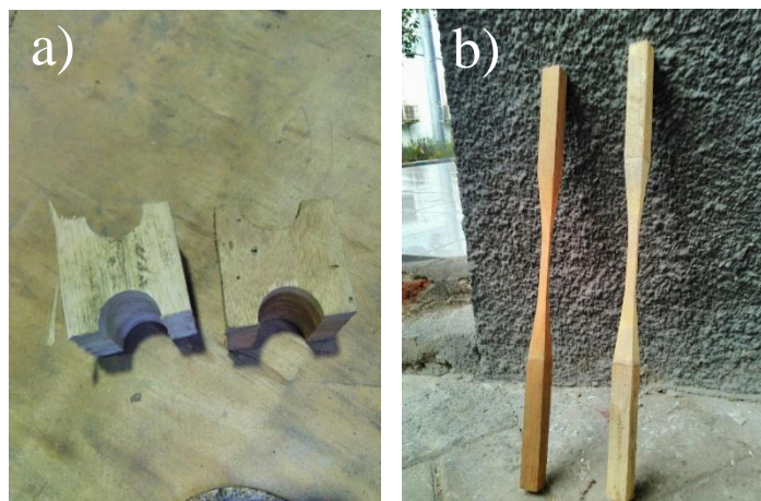
Gambar 3.6 a) spesimen uji tarik tegak lurus serat, b) spesimen uji sejajar serat
