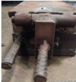
Gambar 4.15 Pemasangan Engsel Pada Cetakan
