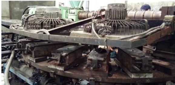
Gambar 3.5 Cetakan yang sudah diletakkan pada Rotary Injection Molding Machine
