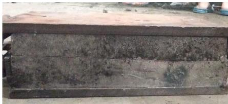
Gambar 4.11 *Insert Cetakan Aluminium kedalam Plat Besi*
