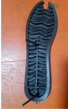
Gambar 4.34 Contoh Cacat Produk Hasil Injection Molding
