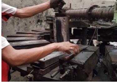
Gambar 4.33 Produk *Sole* Sepatu yang Menempel pada Cetakan Atas
