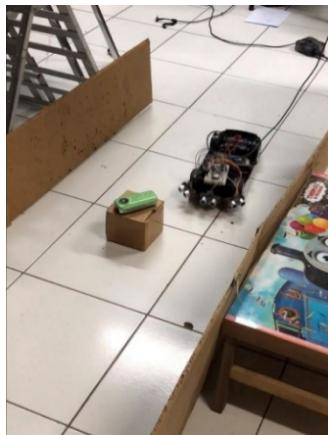
**Gambar 3.23** Pengujian *Hardware* pada Lintasan dengan *Obstacle* 20cm X 20cm
