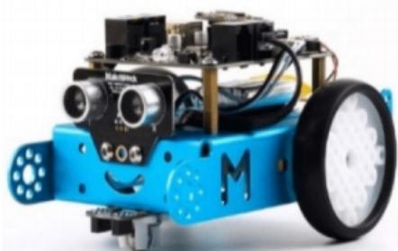
**Gambar 2.1** *Prototype Autonomomus Vehicle* dengan Sensor Ultrasonik (Mbot) (Ismail, Naim, Ayob & Amat, 2017)
