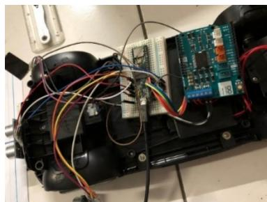
**Gambar 3.10** *Rangkaian Sistem Kemudi pada Prototype*
