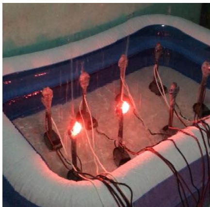
Gambar 4.6 Semburan Air pada 2 Pompa dan Nyala Lampu Merah
