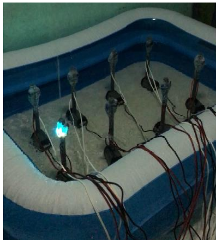
Gambar 4.5 Semburan Air pada Pompa 5 dan Nyala Lampu Biru
