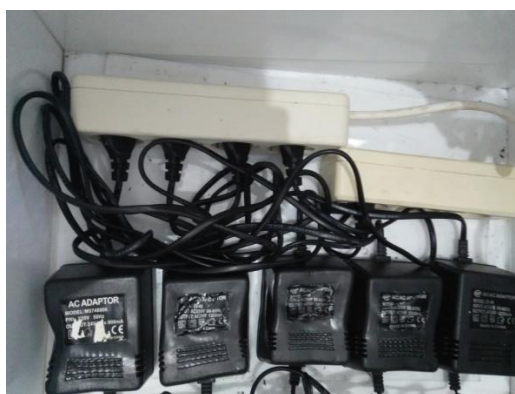
Gambar 4.1 Power Supply Nebulizer yang Mudah Panas selama Pengoperasian
