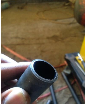
Gambar 4.9 hasil cutting dengan pressure 7 bar
