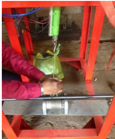
Gambar 4.1 Percobaan untuk mendapatkan gaya tekan pada pipa dengan menggunakan pegas Tarik.
