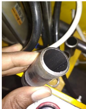
Gambar 4.10 hasil cutting dengan pressure 8 bar
