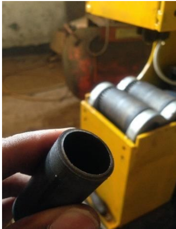
Gambar 4.8 Hasil cutting dengan pressure 6 bar
