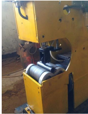
Gambar 4.7 Foto Mesin Pemotong Pipa
