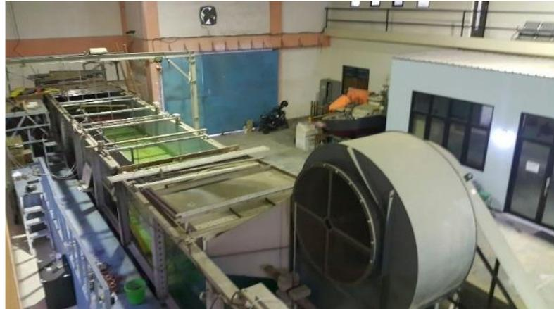
Gambar 3.6 : Flume tank, lab. Rekayasa dasar laut dan bawah laut
