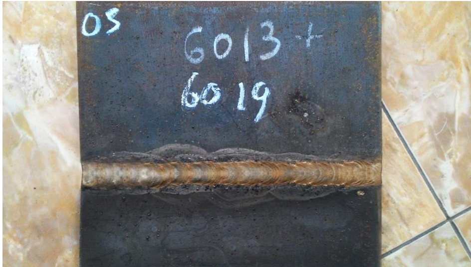
Gambar 4.3 Hasil Pengelasan bawah air pada pelat 12 mm, elektroda 6013 dan 6019.
