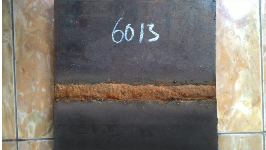
Gambar 4.1 Hasil Pengelasan bawah air pada pelat 12 mm, elektroda 6013.
