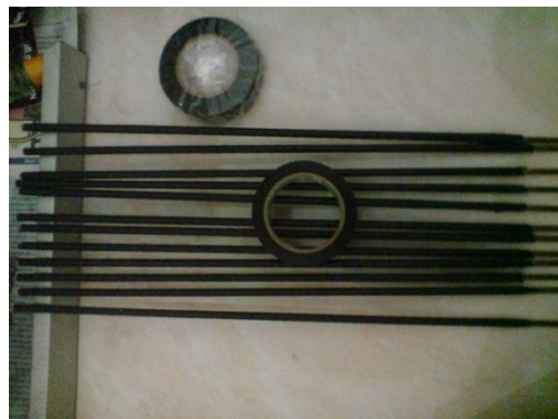
ELEKTRODA YANG SUDAH DI LAPISI ISOLASI
