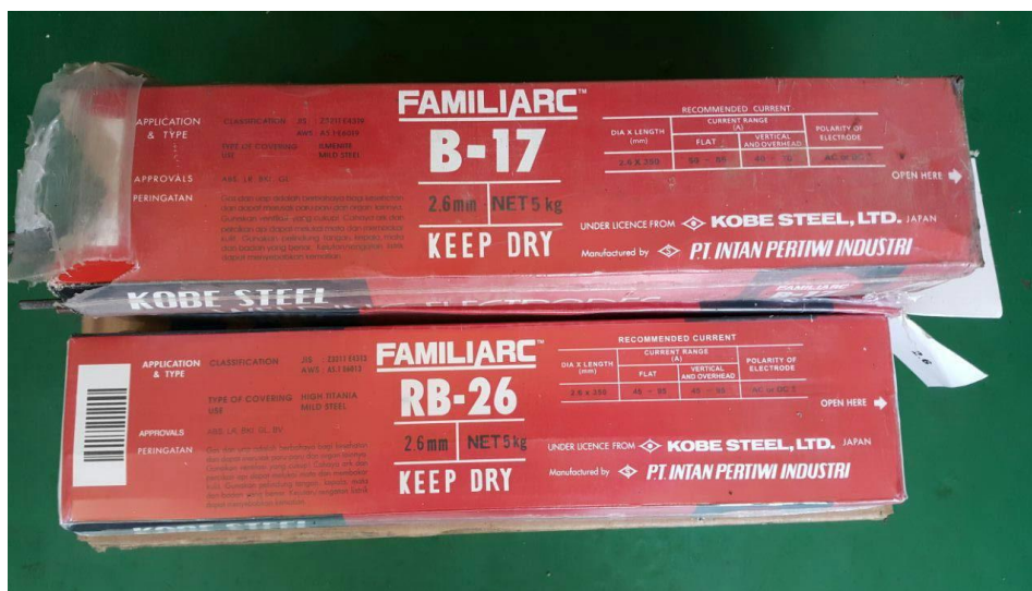
Gambar 3.2 .Elektroda merk KOBE STEEL yang digunakan untuk pengelasan underwater .
