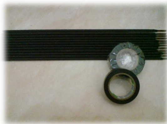
Gambar 3.4. Hasil elektroda yang sudah dilapisi Isolasi
