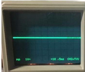
Gambar 4. 4 Gelombang Akumulator di Oscilloscope
