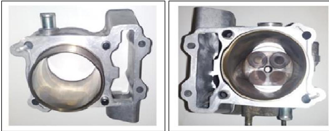
Gambar 3-2: Potongan silinder mesin pengujian
