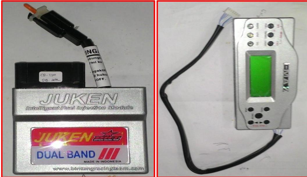
Gambar 3-5: ECU *programmable* dan *display* monitor
