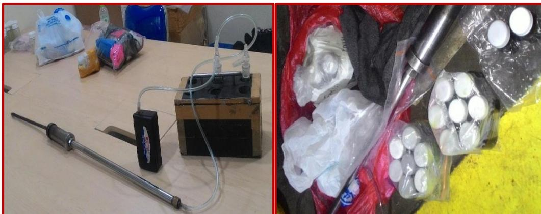
Gambar 3-9: Peralatan bantu pengambilan *formadelhyde* (*probe dan reagent*)
