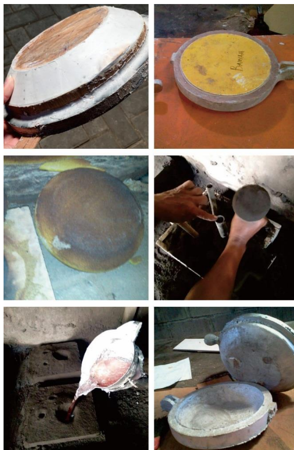
Gambar 4. 31 Proses pembuatan cetakan logam (Sumber: Sitompul,2018)
