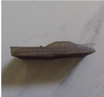
**Gambar 4.16** Letak indentasi pada spesimen 3A kedalaman 8 cm
