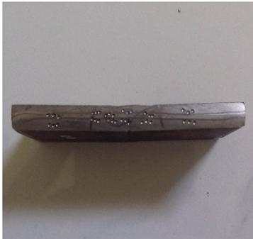
**Gambar 4.19** Letak indentasi pada spesimen 3B kedalaman 15 cm
