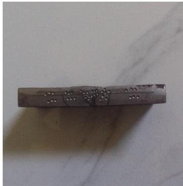
**Gambar 4.17** Letak indentasi pada spesimen 1B kedalaman 15 cm
