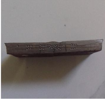
**Gambar 4.18** Letak indentasi pada spesimen 2B kedalaman 15 cm
