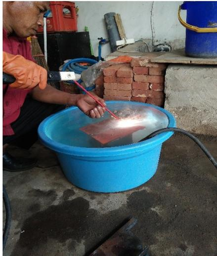
**Gambar 3.5** Proses Pengelasan kedalaman 8 cm.
