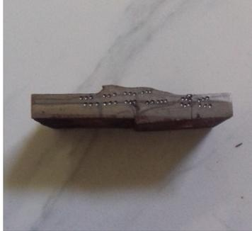
**Gambar 4.14** Letak indentasi pada spesimen
