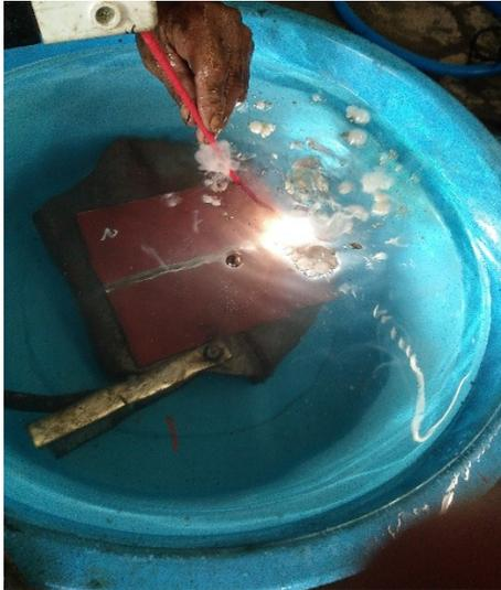
**Gambar 3.6** Proses Pengelasan kedalaman 15 cm
