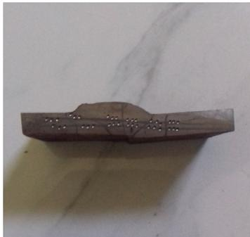
**Gambar 4.15** Letak indentasi pada spesimen
