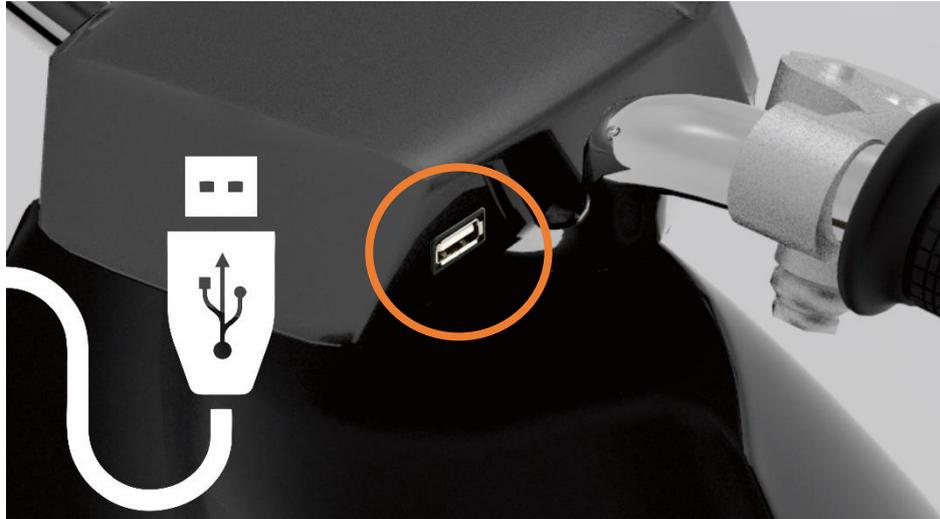
**Gambar 5.27** USB port untuk charging smartphone
