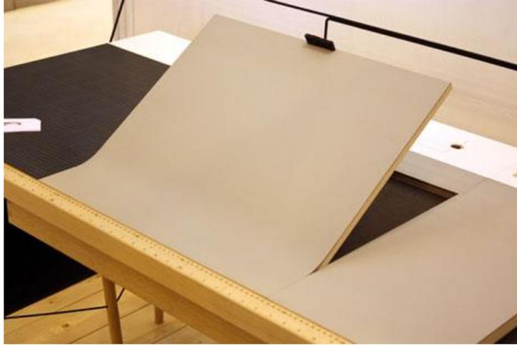
**Gambar 2.12** Posisi meja gambar terbuka miring
