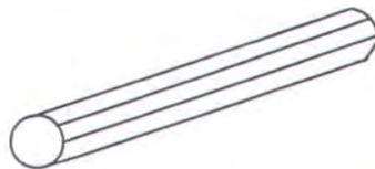
*Gambar II.12 Pasak silinder untuk papan pada lambung*
