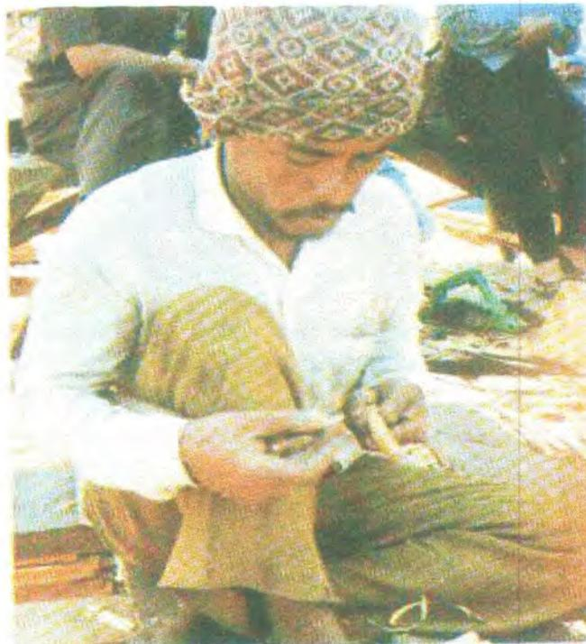
*Gambar II.11 Pembuatan pasak untuk kapal kayu*
