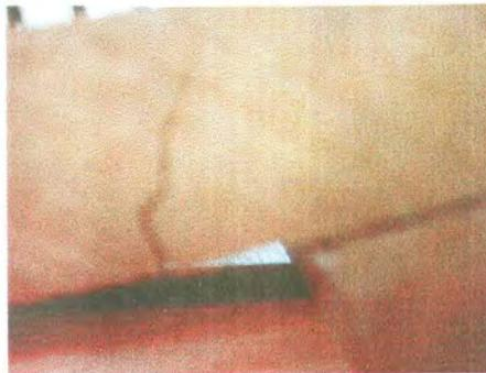
*Gambar kerusakan pada papan setelah pengujian bending*
