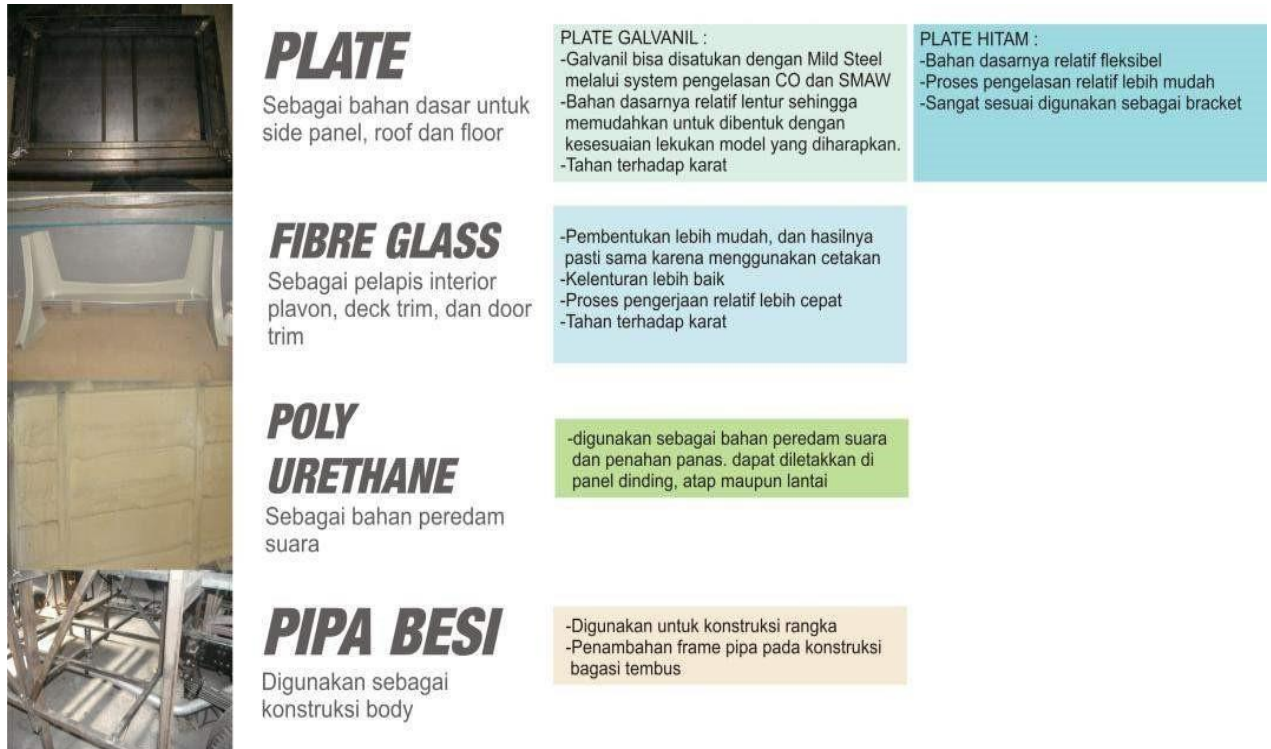
Gambar IV. 23 Material eksisting karoseri (TUGAS ANDA Karoseri, 2014 )
