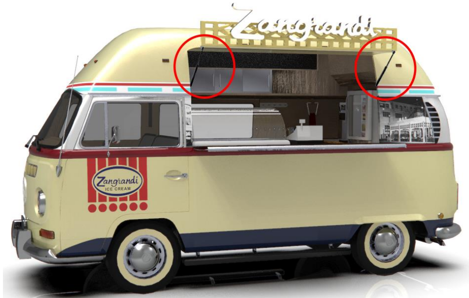
Gambar IV. 29 Contoh pemasangan shock absorber
