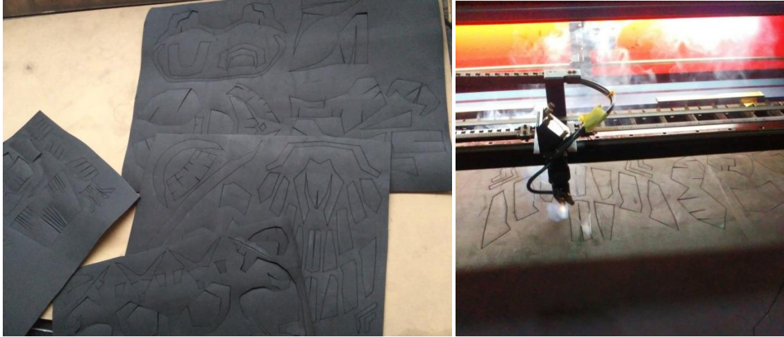
Gambar 4. 30: hasil dan proses dari pemotongan laser
