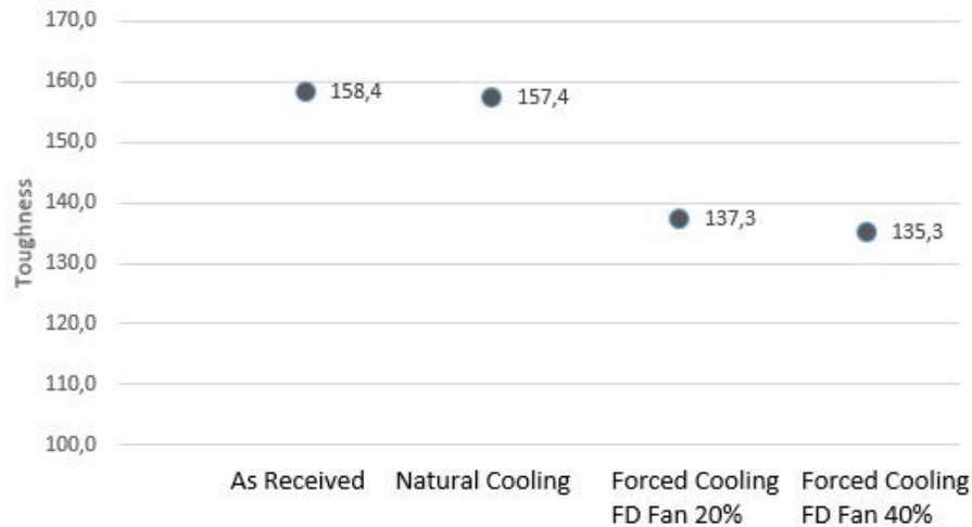
Grafik 4.17 Pengaruh Pendinginan boiler pada kekuatan pada material tube superheater T91 menggunakan natural cooling dan forced cooling dengan 20% dan 40% kapasitas FD Fan
