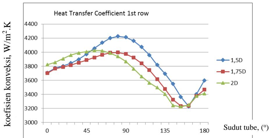
Gambar 4. 15 Grafik Koefisien Konveksi Terhadap Sudut Tube pada Tube First Row
