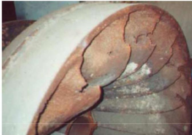
Gambar 2.11 Foto dari *prototype runner* dengan *outlet erosion* pada *blades* disebabkan *bubble cavitation* (Escaler, Egusquiza, Farhat, Avellan, & Coussirat, 2006).
