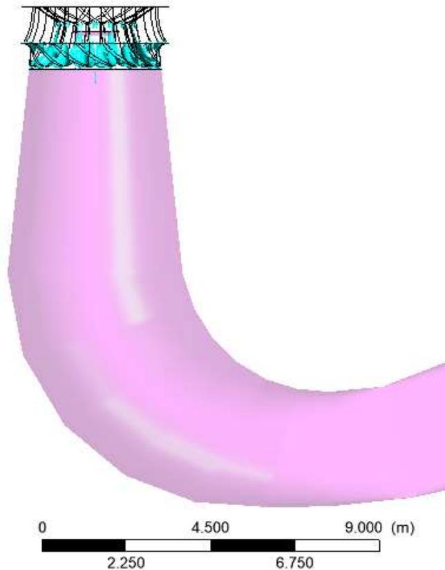
Gambar 4.26 *Vortex rope* dengan model turbulensi DES pada beban 100 %
