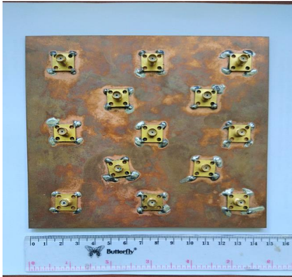
Gambar 4. 1 Realisasi Antena (a) Tampak Sisi Depan (b) Tampak Sisi Belakang
