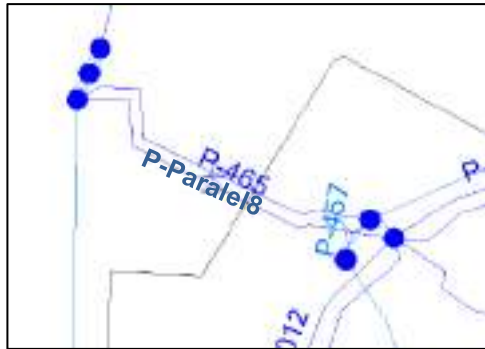
Gambar 5. 6G Penambahan Pipa Paralel 8
