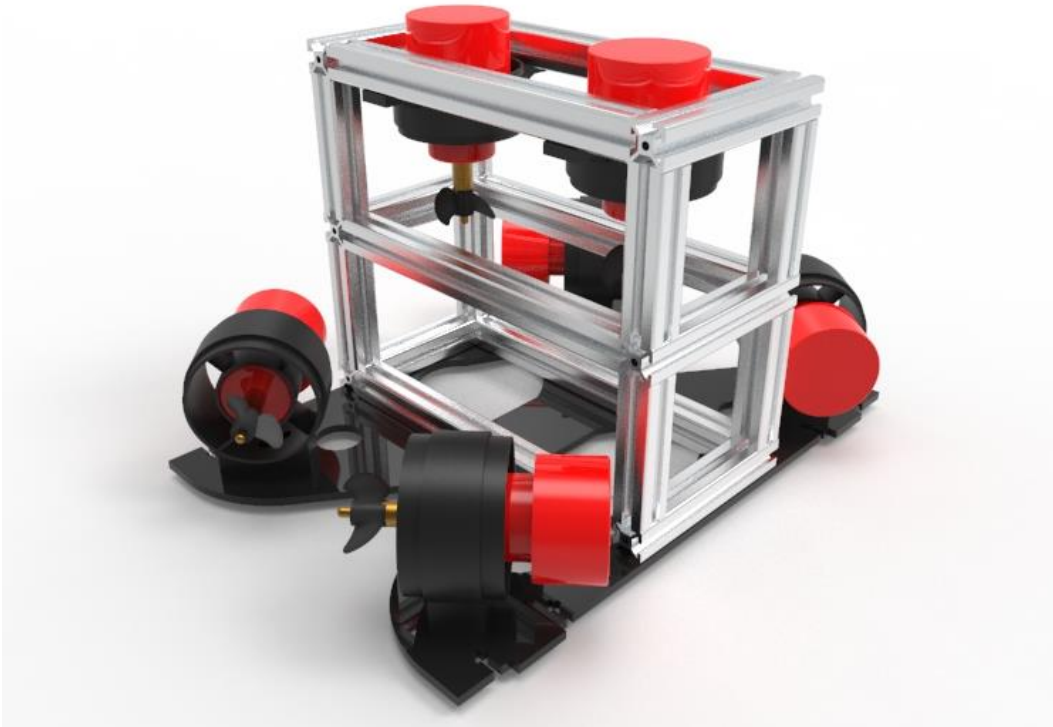
Base samping menggunakan Acrylic
