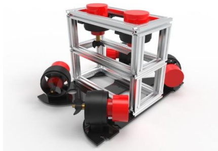
Gambar 3.9 Pemasangan Motor pada Frame ROV
