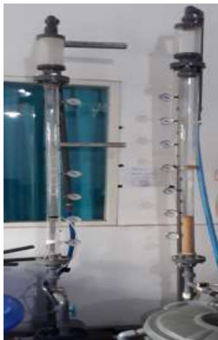
Gambar 3.7. Reaktor Fluidized Bed A (2 kompartemen vertikal) dan B (3 kompartemen vertikal)
