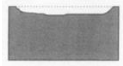
Gambar 2.13 Skema penyerangan uniform corrosion [9]
