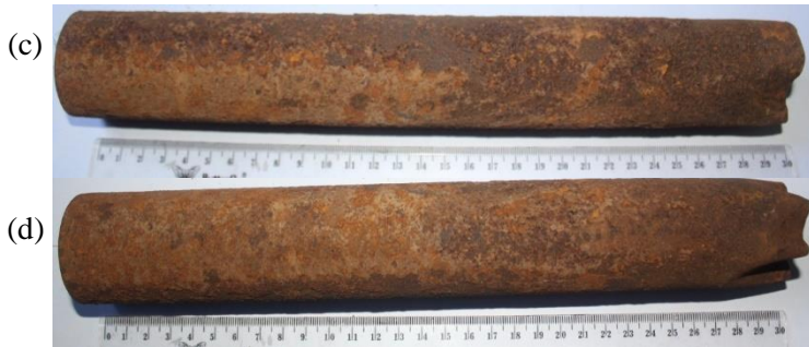
Gambar 1.1 (a) Tube air preheater spesimen 2 tampak depan, (b) tampak belakang, (c) tube air preheater spesimen 3 tampak depan, dan (d) tampak belakang
