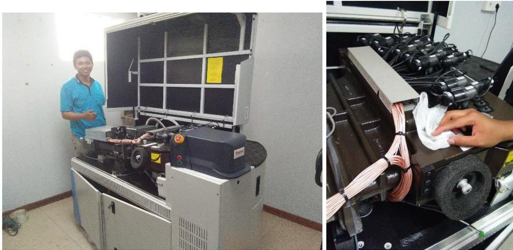
**Gambar 4.4** Kondisi saat proses pemeliharaan instrumen *OES (Optical Emission Spektrometer)*
