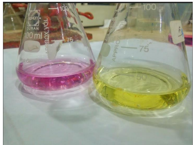
Perubahan warna kuning menjadi ungu pada ion logam Ni^{2+}
