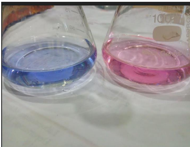
Perubahan warna ungu menjadi biru pada ion logam Pb^{2+}
