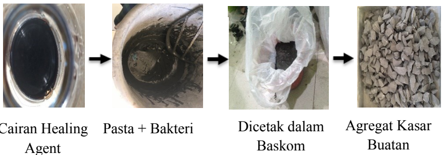
Gambar 3. 2 Proses pembuatan agregat kasar buatan.
