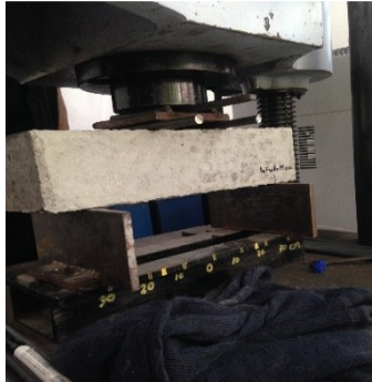
Gambar 3. 27 Pemberian beban untuk menapatkan retak awal pada benda uji balok beton.
