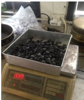
Gambar 3. 10 Menimbang benda uji kering permukaan jenuh ( B_j ).
