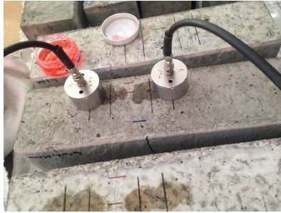
Gambar 3. 41 Transducer dan receiver pada balok beton
