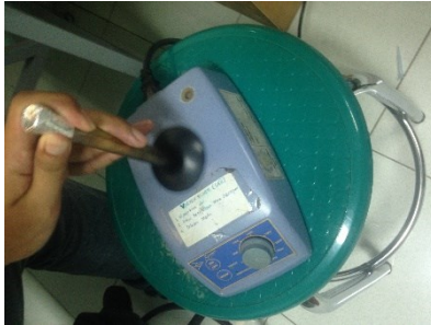
Gambar 3. 34 Proses penggoncangan tabung reaksi menggunakan mesin vortex
