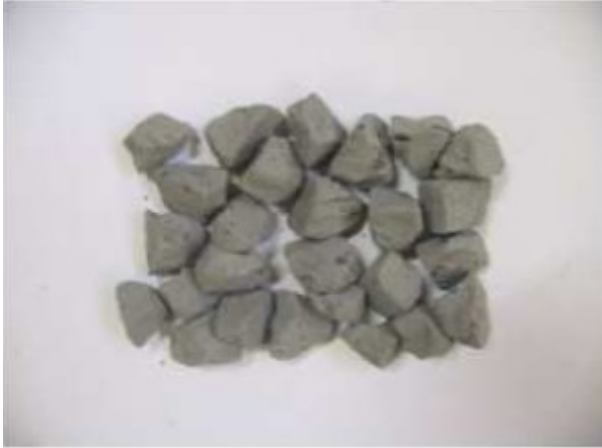
Gambar 2. 11 Bentuk agregat buatan setelah digranulasi
