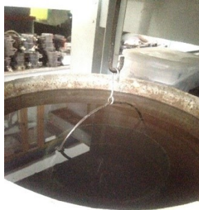
Gambar 3. 11 Menimbang berat benda uji dalam air ( B_a )
