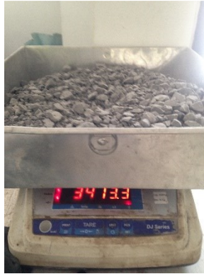
Gambar 3. 14 Menimbang berat benda uji yang tertahan saringan 1,7 mm.
