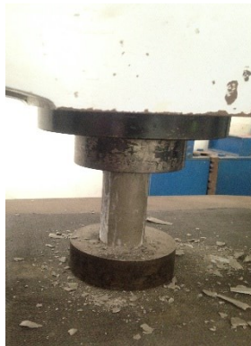
Gambar 3. 32 Pengujian kuat tekan benda uji silinder pasta (Sp)
