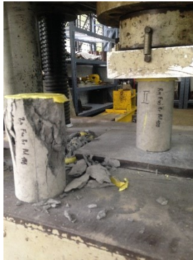
Gambar 3. 31 Pengujian kuat tekan benda uji silinder beton (Sn)
