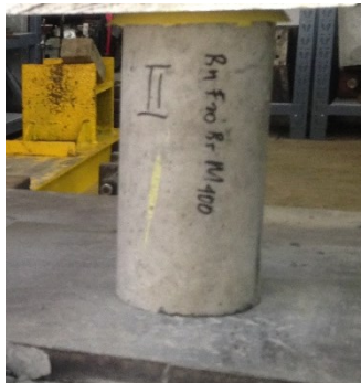
Gambar 3. 22 Benda uji silinder beton yang akan dites tekan
